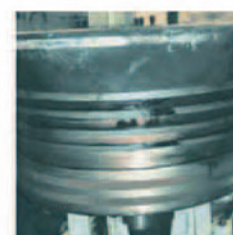
Piston con ADERCO después de 10.223 horas
